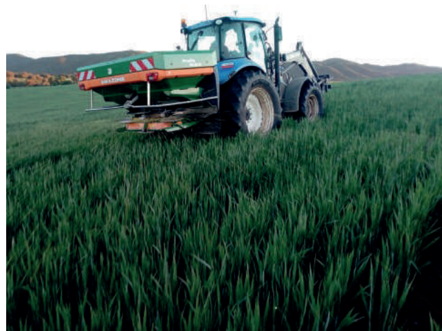
Figura 22. Distribución de fertilizante mediante una abonadora centrífuga (Fuente: proyecto Innovatrigo)
