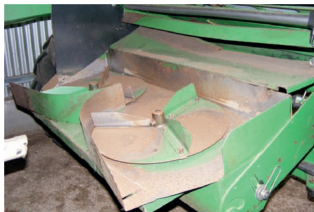
Figura 2. Sistema detallado esparcidor de residuos en la cosechadora de cereales (Fuente: European Conservation Agriculture Federation (ECAAF))
