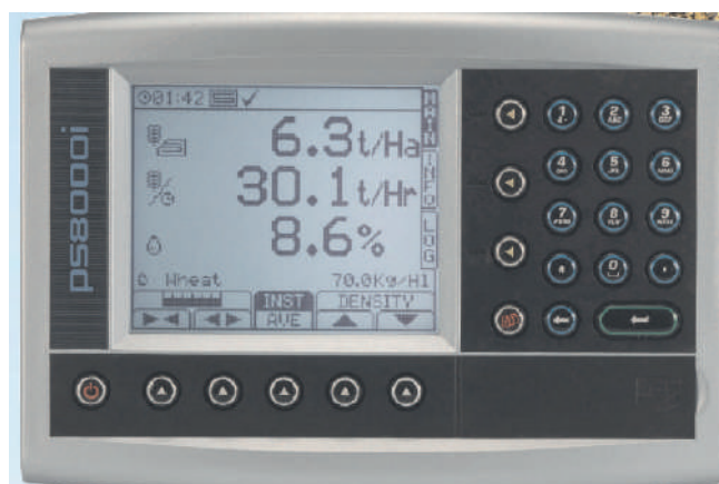
Figura 11. Pantalla de monitor de rendimiento Ceres 8000i (Fuente: RDS Technology)
