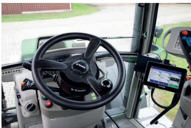
Figura 9. Sistema móvil acoplado directamente sobre el volante (Fuente: Trimble)
