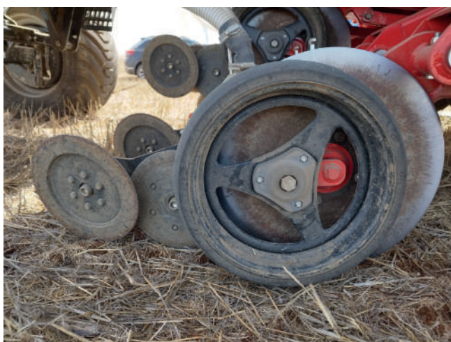
Figura 3. Sembradora directa monodisco de cereal (Fuente: Antonio M. Conde López)
