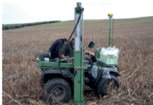
Figura 13. Quad preparado para muestrear suelo (Fuente: proyecto Innovatrigo)
