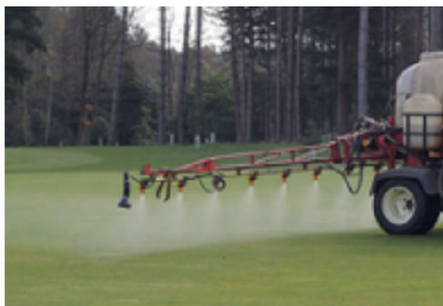
Figura 18 (arriba/abajo). Comparación en el uso de boquillas estándar y antideriva (Fuente: proyecto Topps-Prowadis)
